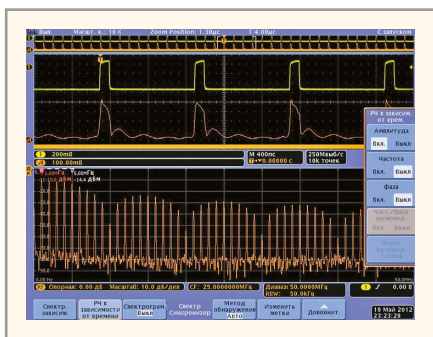
Рис. 10. Построение сигнала по данным ограниченного спектра
