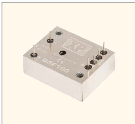
Рис. 10. Модуль защиты от импульсных помех DSF100
