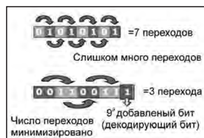
Рис. 5. Принцип перекодирования информации при переходе к TMDS
