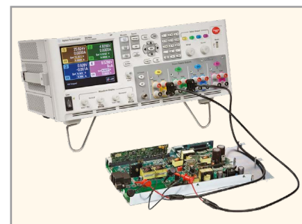
Рис. 13. Анализатор источников электропитания фирмы Agilent
